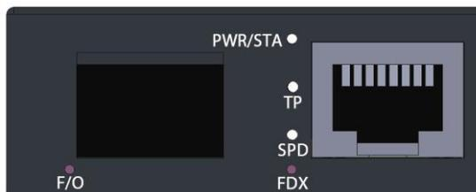
図 2. WDM及びSFPタイプの前面パネル
