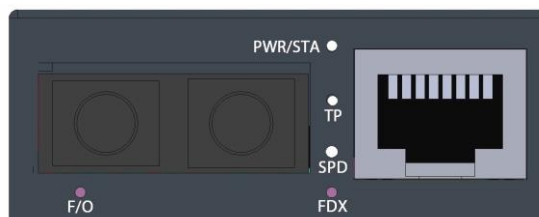
図 1. 2心ファイバタイプの前面パネル
